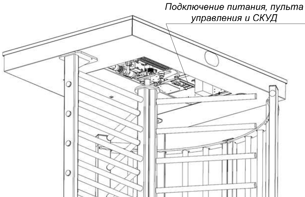
Рис. 15. Расположение кросс-платы на верхнем модуле турникета.
